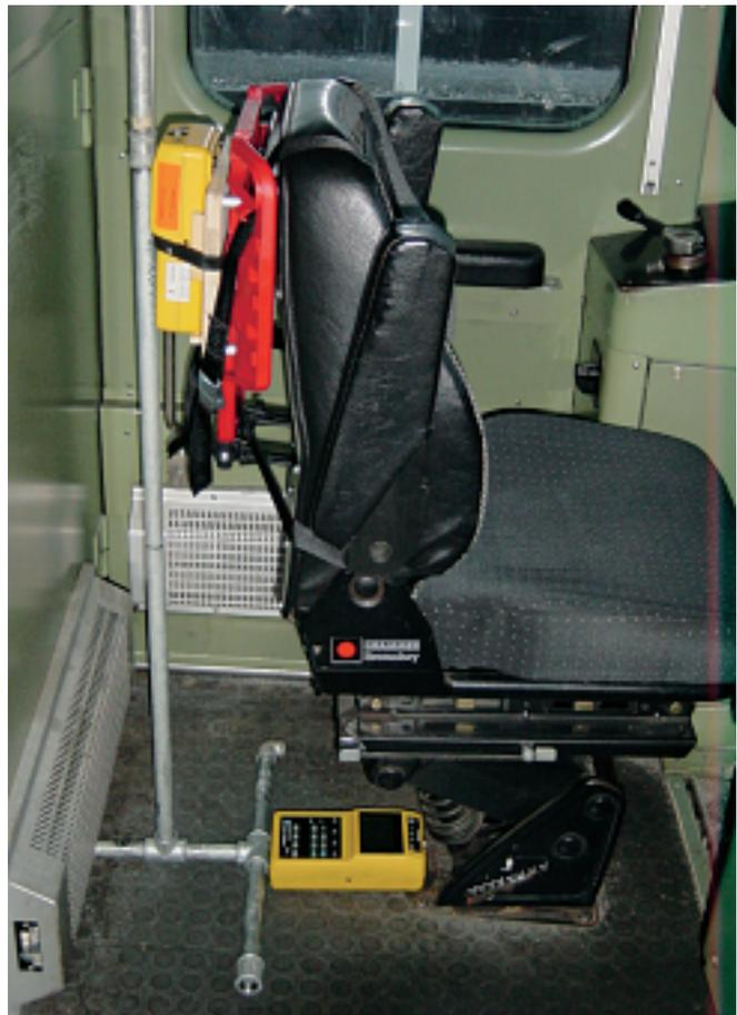
**Bild 1:** EMF backpack® montiert am Triebfahrzeugführersitz im Führerstand des Triebwagens RBDe 560 (NPZ).
