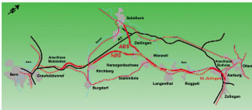
**Bild 1:** Situationsplan der Neubaustrecke Mattstetten – Rothrist (NBS 45 km), Ausbaustrecke Wanzwil – Solothurn (ABS 9 km) und Verbindungslinie Rothrist – Zofingen (VL 2 km) zwischen Bern und Olten. Die bestehende Strecke (Stammlinie) über Burgdorf – Herzogenbuchsee erlaubt teilweise Höchstgeschwindigkeiten von 85 km/h.
